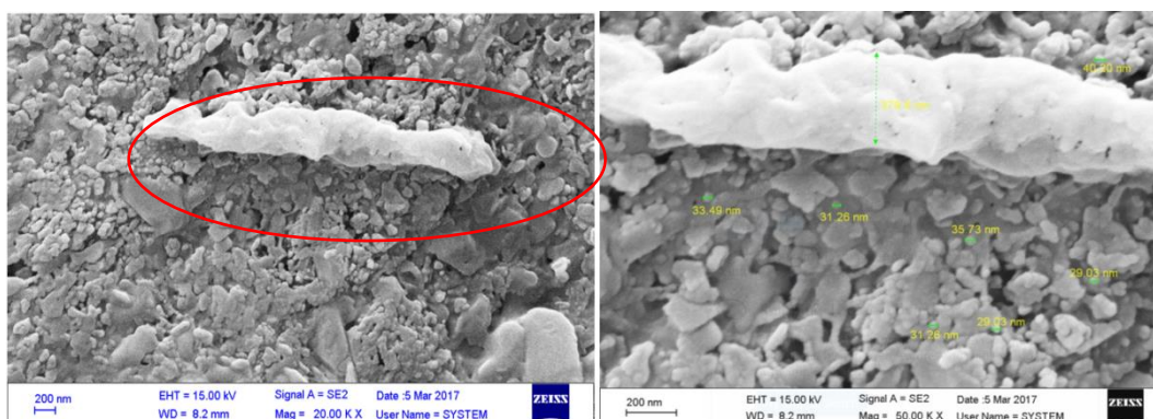
شکل ۴- تصویر میکروسکوپ الکترونی روبشی از نمونه جداشده از پساب فراوری آهن
