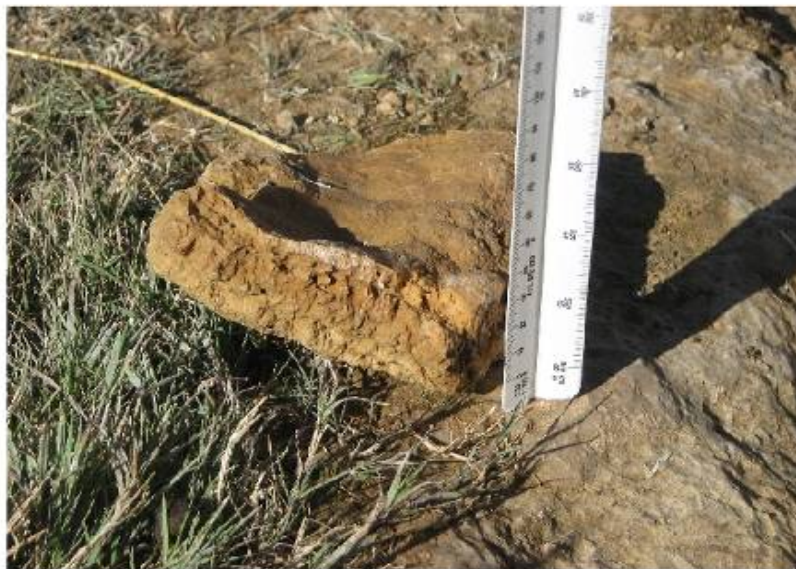
شکل ۲: میزان املاح نهشته گذاری شده در بستر جوی اصلی که در مدت ۱۶۰ روز تشکیل شده‌اند. بخشی از این نهشته‌ها برای بررسی بیرون آورده شده است. جوی اصلی جنوب غربی سکوی آهکی تخت سلیمان
